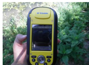
Saisie d'un point GPS (GPS Trimble Geo 5T)
